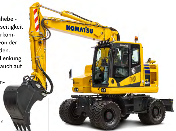
Abb. oben: Die überarbeiteten Komatsu Mobilbagger erfüllen nun die Abgasvorschriften gemäß EU Stufe V.
