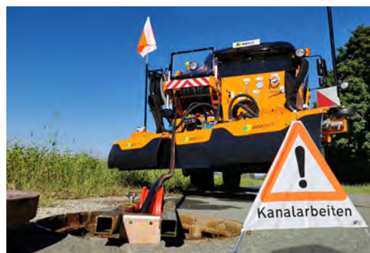
Damit lassen sich Rohre, Rinnen und Durchlässe mit bis zu 60 cm Durchmesser von Ablagerungen, Schlamm, Wurzeleinwuchs und Laub befreien.
