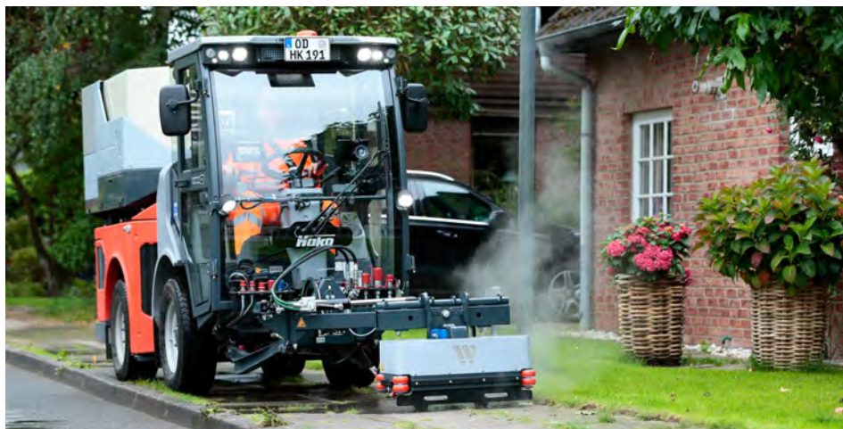
Perfekt aufeinander abgestimmt: Exklusiv für Hako entwickelt weed concept Auf- und Anbauten für die Wildkrautbekämpfung.
