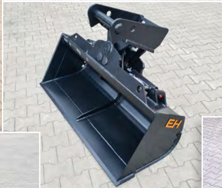
Hydraulischer Grabenräumlöffel mit Lasthalteventil, passend für Lehnhoff MS08, 1.400 mm Breite.
