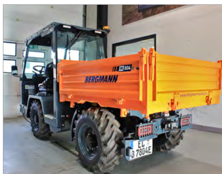
Abb. links: Standardmäßig ist der M804e mit einer Drei-Seiten-Kipp-Pritsche ausgestattet, aber auch zahlreiche Anbauten wie Bewässerungsanlagen, Schneeschilde oder Kehrbesen sind möglich.
