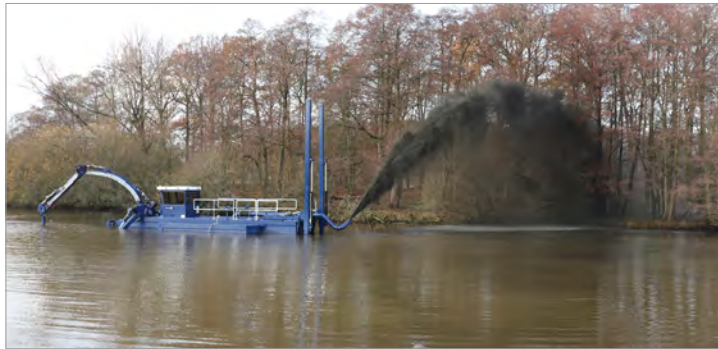
Der BERKY Dredge King etwa ist in der Lage, den Faulschlamm mittels Schlammpumpe mit einer Förderleistung von bis zu 240 Liter pro Minute vom Gewässergrund abzusaugen.
