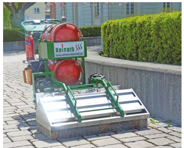
Mit der handgeführten X 1050 A von Reinert Metallbau geht es dem Wildkraut gezielt mit Feuer an die Wurzel.
