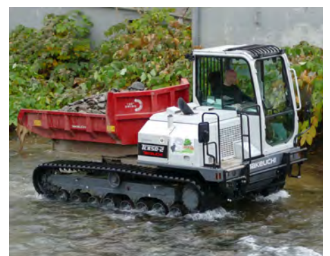
Auch unter schwierigsten Bedingungen transportiert der Takeuchi Dumper TCR50-2 3,7 Tonnen.
