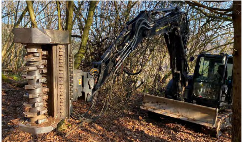
Mit dem Forstmulcher am Baggerarm erreicht Oberle auch schwieriges Gelände
