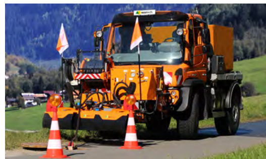
Besonders nach Unwettern werden mit dem ecotech Kanalspülgerät KSG Verunreinigungen aus Röhren, Rinnen und Wasserdurchlässen an Straßen beseitigt.
