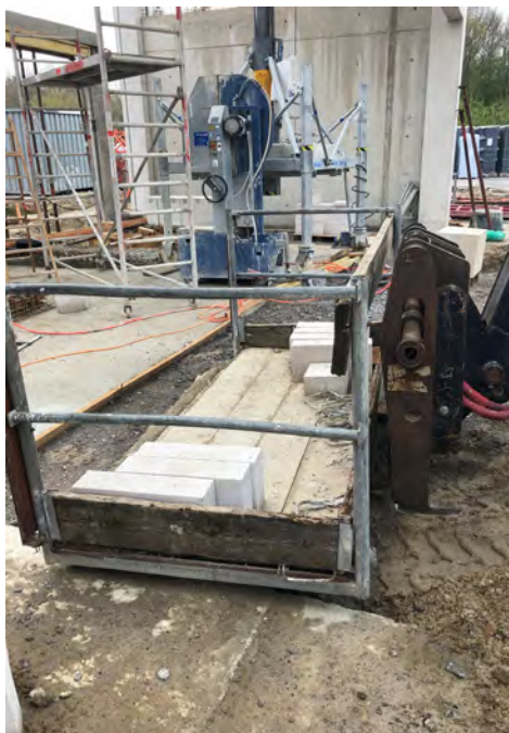
Abb. links: Teleskopstapler mit... ja, was eigentlich? Arbeitsbühnen für Teleskopstapler müssen vom Gerätehersteller zugelassen sein. Eigenbau führt oft zum Unfall. Foto: Tischendorf
