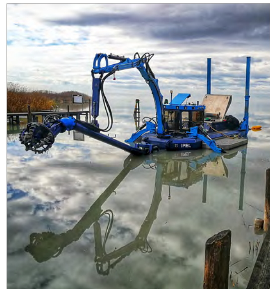
Um den Faulschlamm effizient aus dem Gewässer zu entfernen, bieten sich ein Saugbagger oder ein Schlammredger an. Hier wird die Schlammschicht nach dem Staubsauger-Prinzip einfach abgesaugt.
