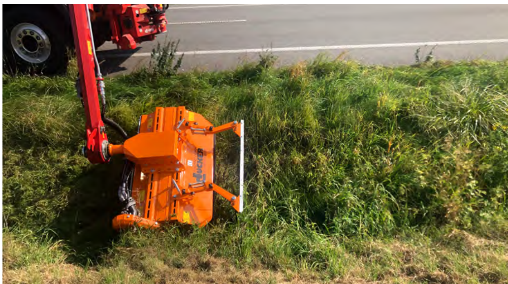
Eine Lösung für insektenschonendes Mähen ist der Schlegelmähkopf VMS 1200 ÖKO.
