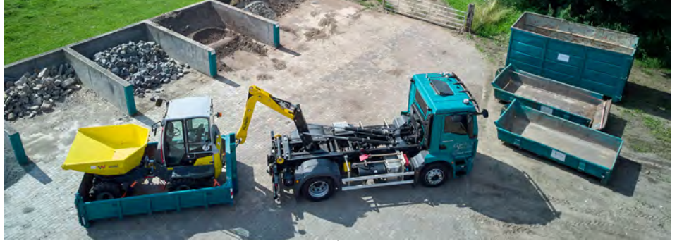
Aufgrund der ausgefeilten Armgeometrie bietet der „Power A“ einen extrem flachen Aufnahmewinkel sowie enorme Kraft am Haken. Dadurch entsteht eine große Bandbreite an möglichen Einsatzzwecken.
