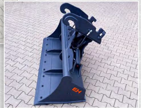
Hydraulischer Grabenräumlöffel mit Unterschraub-Wendemesser, passend für Verachtart CW30, 2.000 mm Breite.
