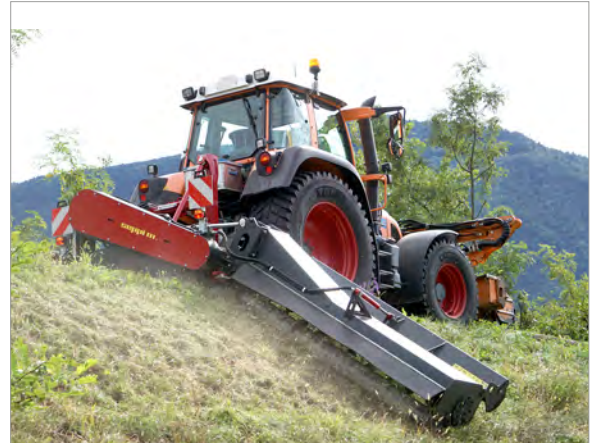
Das Gerät arbeitet mit einer großzügigen Parallelogramm-Seitenverschiebung weit rechts der Traktorspur und ermöglicht so ein sichereres Arbeiten weit ab von der Böschungskante.
