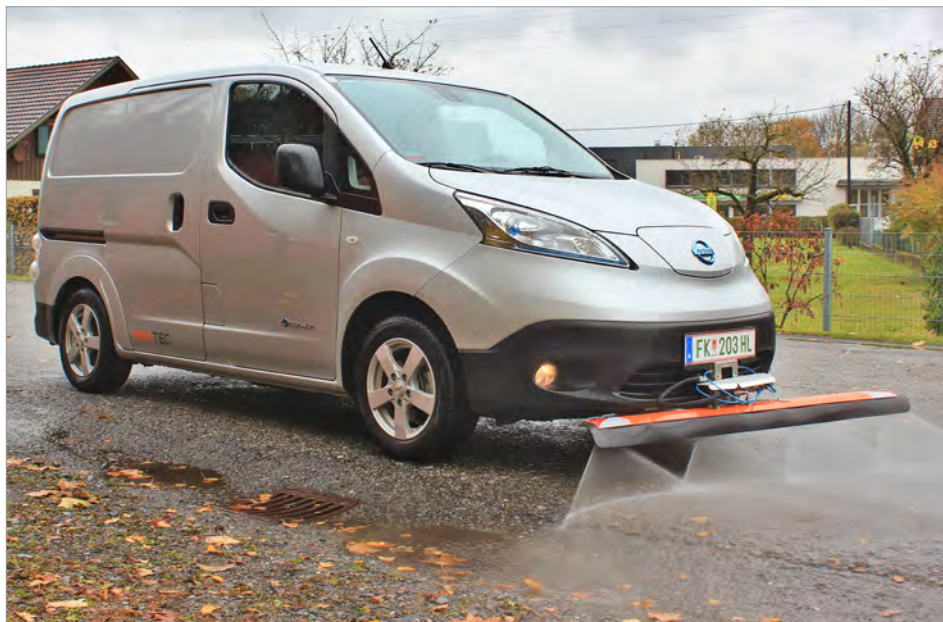
Druckstark auf der Straße: Der Frontwaschbalken kann pneumatisch verstellbar werden und eignet sich zur Reinigung von Straßen, Tiefgaragen und weiteren versiegelten Flächen.
