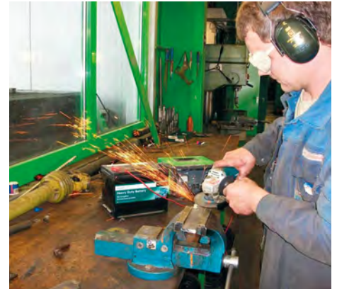
Beim Schleifen und Trennen müssen Schutzbrille und Gehörschutz getragen werden. In der Nähe von Batterien sollten funkenreißende Werkzeuge aber niemals eingesetzt werden.
