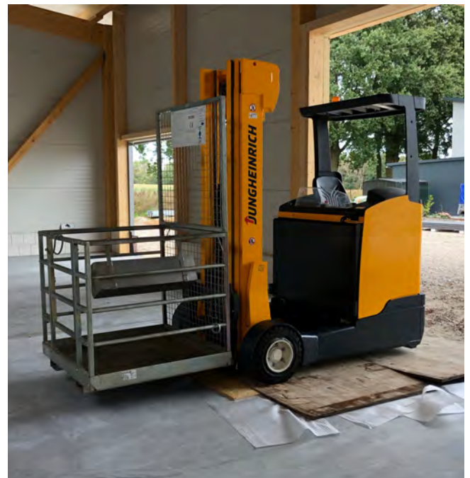
Abb. links: Teleskopstapler mit... ja, was eigentlich? Arbeitsbühnen für Teleskopstapler müssen vom Gerätehersteller zugelassen sein. Eigenbau führt oft zum Unfall. Foto: Tischendorf
