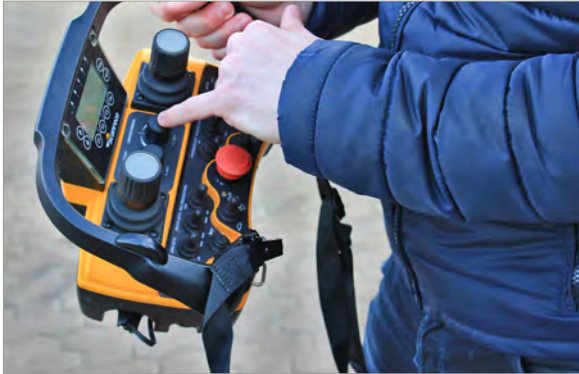
Bei der Fernbedienung der Funkraupe setzen die Meppener auf Individualität. So lassen sich die beiden Joysticks je nach Präferenz des Anwenders belegen.
