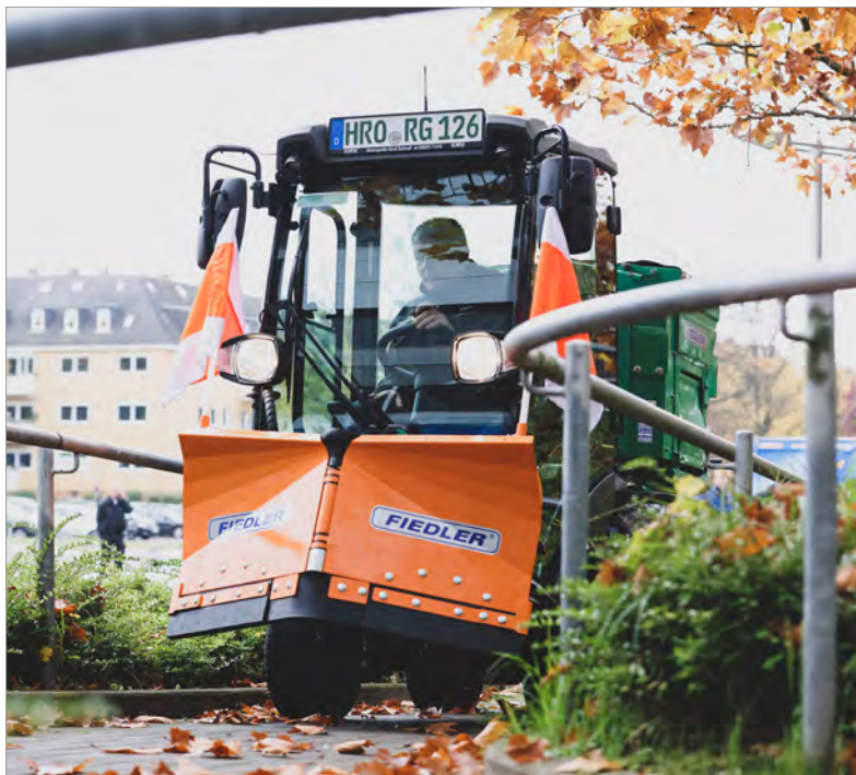
Abb. links: Für die meist engen Wege der Hansestadt brauchte es möglichst wendige und kompakte Fahrzeuge. Die Knicklenkung erlaubt randnahe Arbeiten und das einfache Umfahren von Hindernissen: Da der Hinterwagen exakt in der Spur des Vorderwagens fährt, muss weniger gestaucht werden als etwa mit Kompakttraktoren. | Insgesamt zwölf neue Kärcher-Fahrzeuge für den Winterdienst hat die Rostocker Gehweg Reinigung vor kurzem erhalten. (Abb. rechts)
