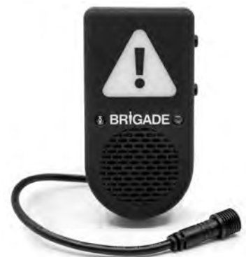
Display: Eine automatische Helligkeitsregelung bedeutet, dass sich SidescanPredict auf die Lichtbedingungen im Fahrerhaus einstellt, sodass die optische Warnung nicht unter den vielen Leuchtanzeigen einer modernen Lkw-Kabine verloren geht.
