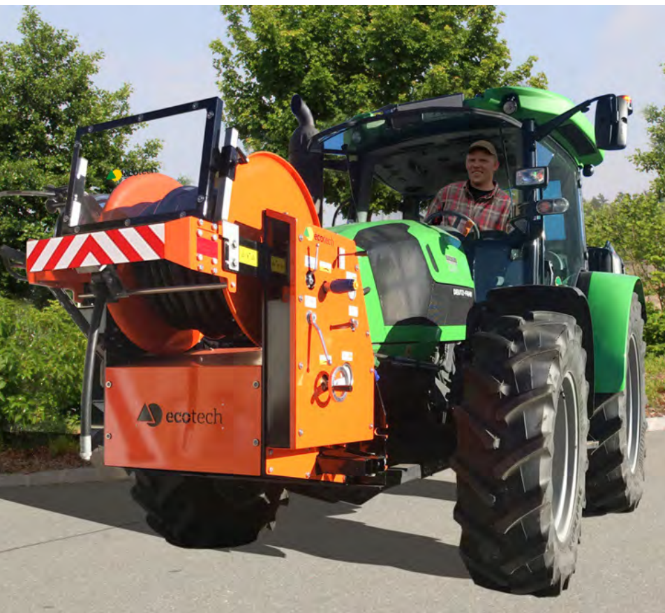
Besonders nach Unwettern werden mit dem ecotech Kanalspülgerät KSG Verunreinigungen aus Röhren, Rinnen und Wasserdurchlässen an Straßen beseitigt.
