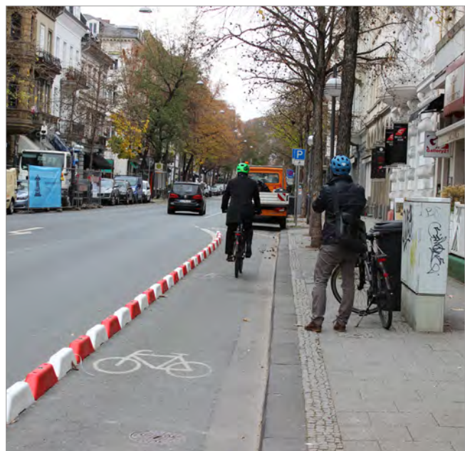
Durch zielführende Zusammenarbeit der Mitarbeiter der Landeshauptstadt Wiesbaden aus dem Tiefbau- und Vermessungsamt und der Lüft GmbH wurde ein bereits bewährtes Erhöhungselement aus massivem Kunststoff modifiziert, um das Überfahren der Markierung zu unterbinden.
