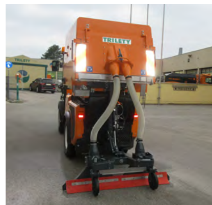
Das MTK3-System arbeitet mit einer leistungsstarken hydraulisch angetriebenen Turbine, welche genügend Unterdruck im Saugbehälter erzeugt, um Flüssigkeiten verschiedenster Art aufzusaugen zu können.
