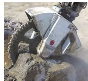
Mit dem DMW Schneidrad lassen sich Betonmauern ebenso schneiden wie gewachsener Fels.
