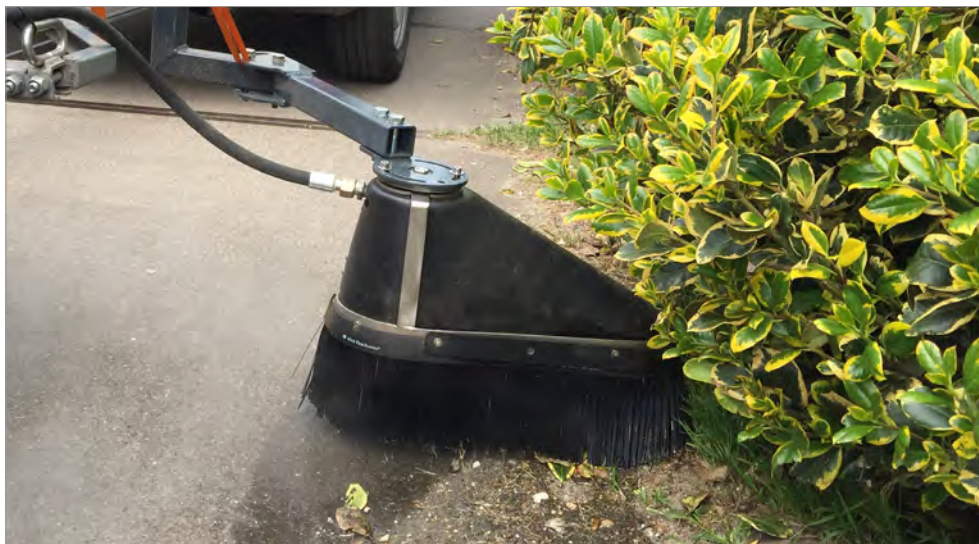
Abb. links: Neben der Verwendung einer Sprühlanze und eines Handwagens ist auch die Kombination des BioMant Compact mit einem Ausleger und Flex-Spritzschirm möglich.
