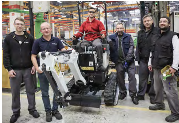
Abb. Gruppenbild: Der E10 heißt jetzt E10z, um zu verdeutlichen, dass es sich um einen Minibagger in Kurzheckbauweise (Zero Tail Swing) handelt.
